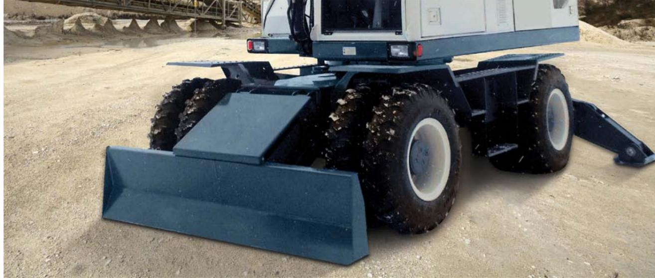
**Опора-отвал** с параллельным движением ножа обладает повышенной прочностью. Гидроцилиндры и гидроразводка привода отвала надежно защищены от воздействий внешней среды
